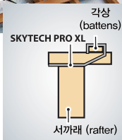
각상(battens)을 이용한 후레싱(flashings) 처리
