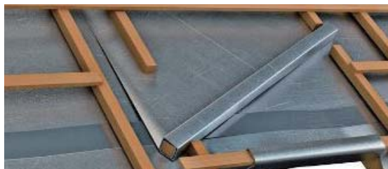
각상(battens)을 이용한 후레싱(flashings) 처리
