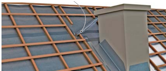
굴뚝 위 후레싱(Flashing) 처리
